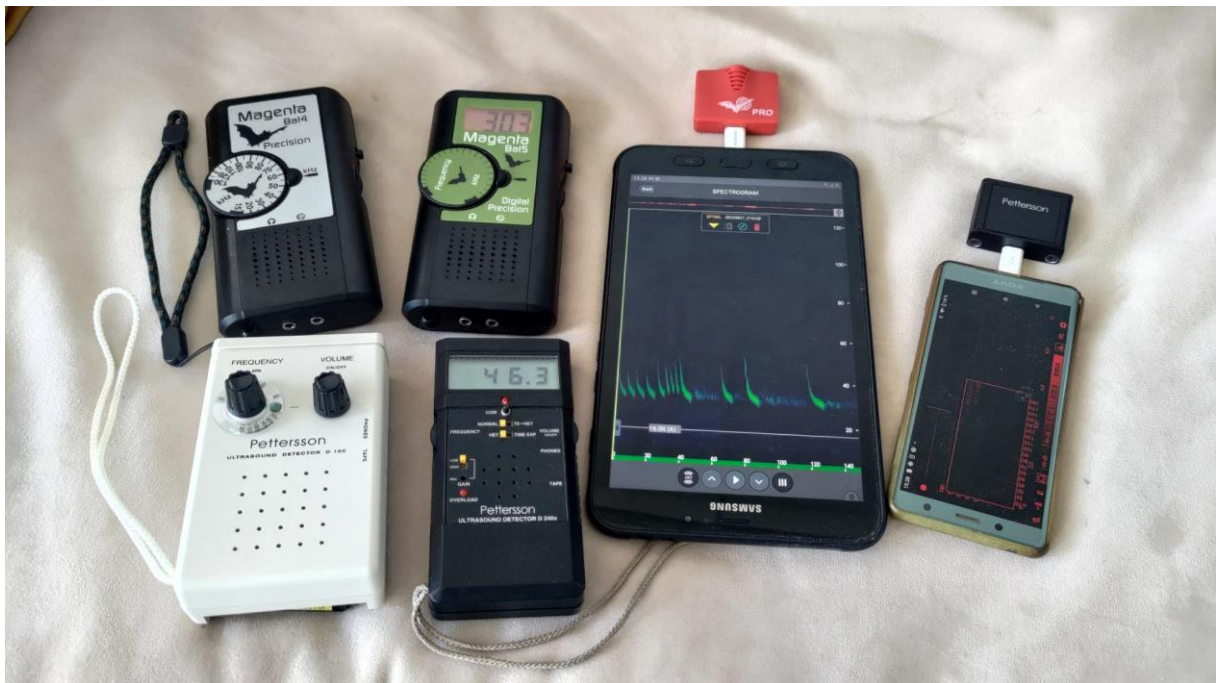
Kuva 21. Erilaisia detektoreja. Heterodyne-tekniikan laitteita: vasemmalla ylhäällä Magenta Bat4, vieressä oikealla Magenta Bat5 sekä vasemmalla alhaalla Pettersson D100. Aikalaajennustekniikan laitteita: keskellä alhaalla Pettersson D240x, tablettiin liitettyä Wildlife Acoustic Echo Meter Touch 2 PRO ja oikealla puhelimeen liitettyä Pettersson u384-mikrofoni (Timo Metsänen).
